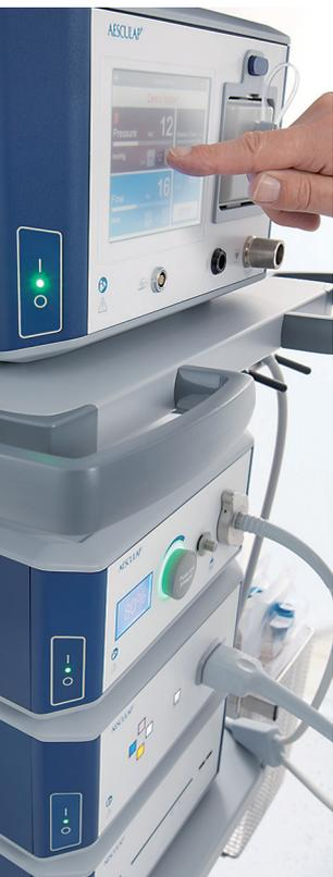
L'insufflateur Flow50 offre un débit augmenté à 50l/min<sup>8</sup>.
